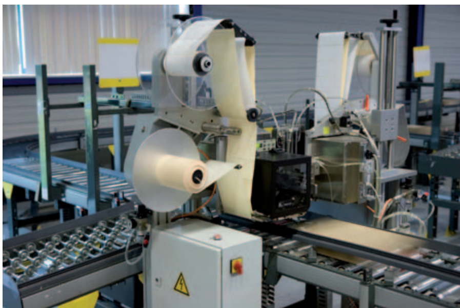
Machine d'étiquetage contrôlée par un automate programmable Série MELSEC L.
